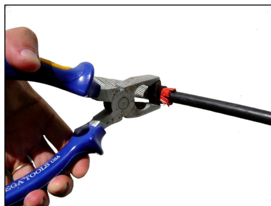
FIG. 7 – Aperto da Braçadeira TUB
